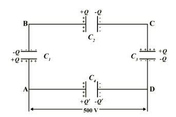
$$\frac{Q}{C} + \frac{Q}{C_2} + \frac{Q}{C_3} = 500V$$
